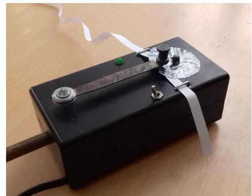
Prvi zadatak izvršit ćete tako da elektromagnetno tipkalo stavite na stol. Papirnatu traku uvučete ispod indigo papira i uhvatite je za jedan slobodan kraj. Uključite elektromagnetno tipkalo i vučete traku dok ne napravite jedan do dva koraka normalnog hoda. Na papirnatoj traci ostaju točkice koje su nastale u jednakim vremenskim intervalima. Razmak između dvije točkice na traci predstavlja put koji ste napravili u intervalu od 0.02 s.
